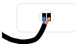
Après avoir préalablement dénudé les conducteurs Phase et Neutre sur 5mm, les insérez dans les borniers. Neutre à Gauche.
