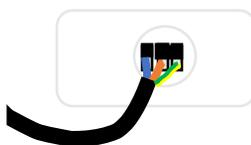
Après avoir préalablement dénudé les conducteurs Phase et Neutre et la terre sur 5mm, les insérez dans les borniers.
