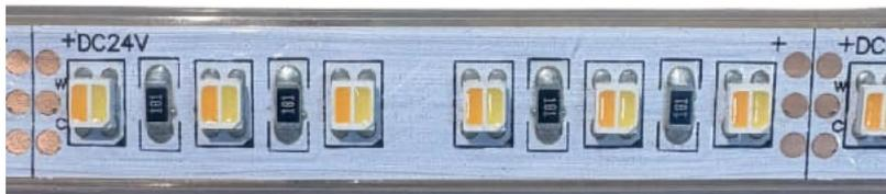
Le ruban LED **FLCCT-ET** est une solution d'éclairage étanche, flexible et performante, offrant une température de couleur ajustable de 2700K à 6000K, avec une puissance de 20W/m et une efficacité lumineuse de 90 lm/W.
