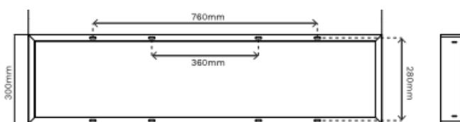
Repérer les emplacements des perçages suivant les schémas dimensionnels, percer et insérer des chevilles en fonction du support de montage
