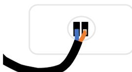
Après avoir préalablement dénudé les conducteurs Phase et Neutre sur 5mm, les insérez dans les borniers.
